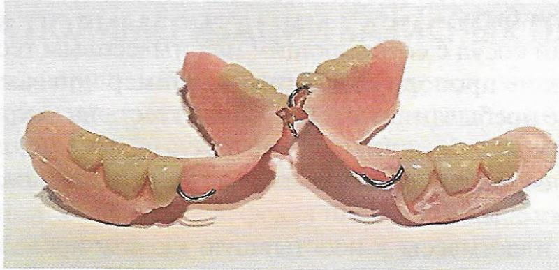
Рис. 6.11. Пористость сжатия в съемных пластиночных протезах
