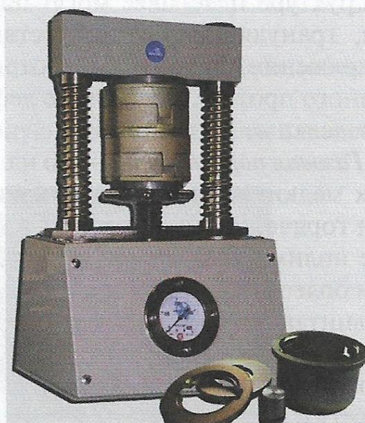
**Рис. 6.7.** Кюветы, установленные в гидравлический пресс
